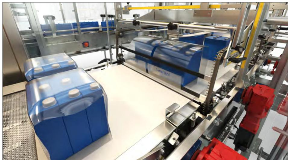
La macchina impiega un concetto di design collaudato all'ingresso per la movimentazione del prodotto e la formazione di fardelli, producendo pacchi quadrati strettamente avvolti che garantiscono l'integrità dei cartoni e una manipolazione sicura. La stazione di avvolgimento del film funziona in modalità continua senza barra saldante ed il film viene sigillato sotto il nastro.
