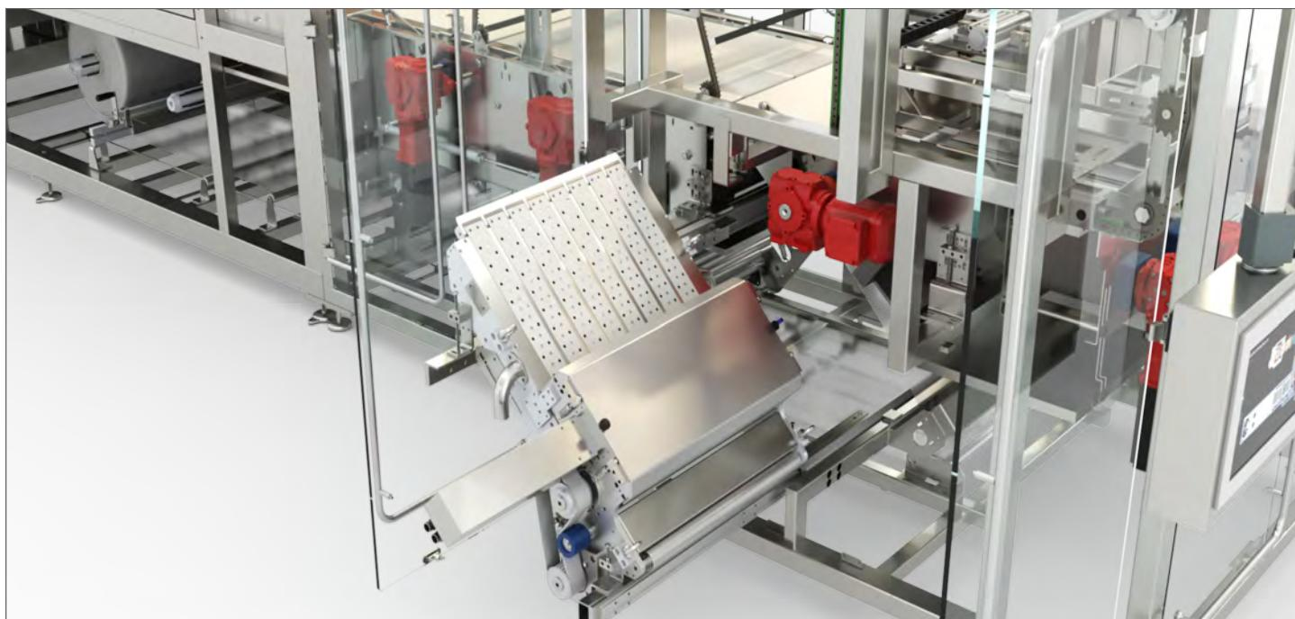
**Sistema de desenrollado/corte de la película completamente extraíble para simplificar las operaciones de mantenimiento.**
