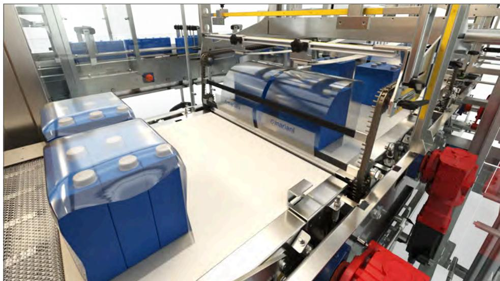
Para la entrada, manipulación del producto y formación de los packs, se usa un sistema sumamente probado que permite hacer agrupaciones cuadradas y compactas, estrechamente enfardadas, que permiten la integridad del producto y una manipulación segura. El sistema de envoltura tiene un funcionamiento continuo, sellándose el plástico debajo de la cinta.
