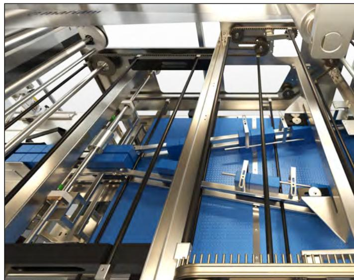
Los paquetes, son envueltos en el plástico antes de entrar en el túnel de termorretracción, de donde saldrán como packs estables y bien envueltos. El multipack se forma gracias a una unidad de soldadura y corte que garantiza el cierre perfecto del plástico.
