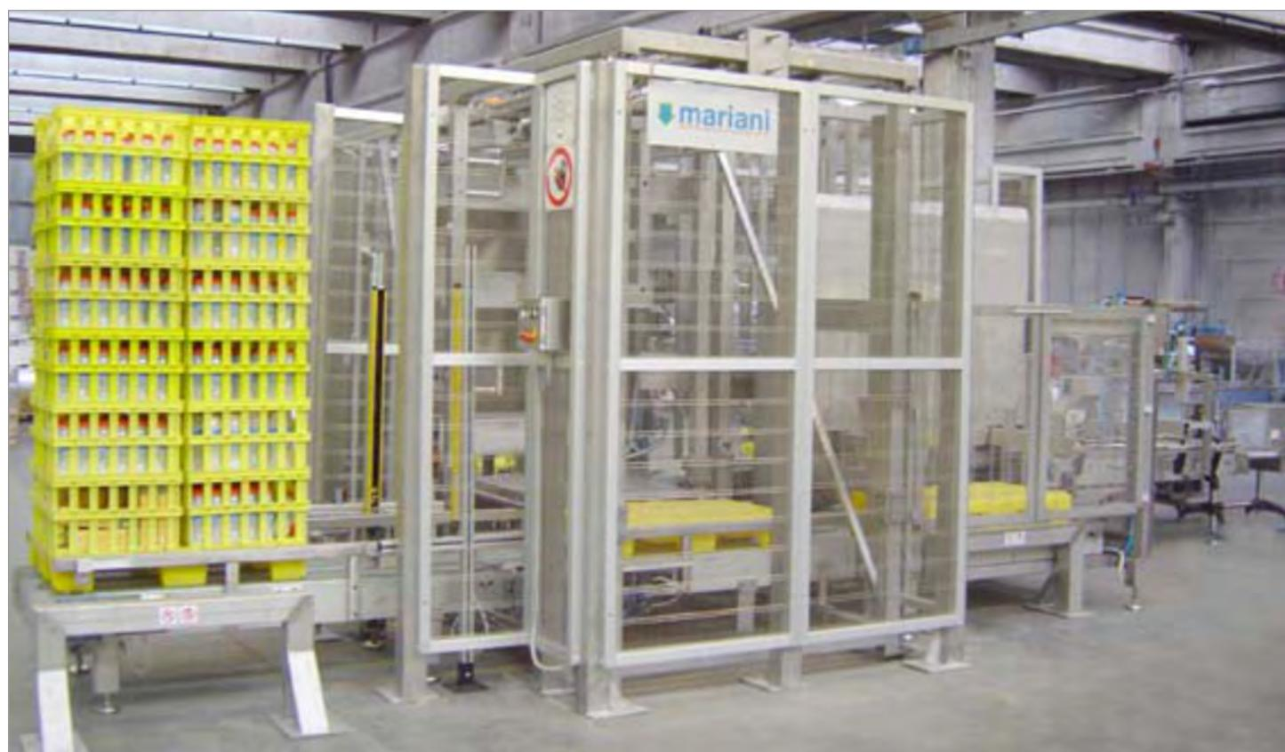
Macchina progettata per palletizzare pile di casse di plastica o secchi di metallo mod. **PMP-465**
