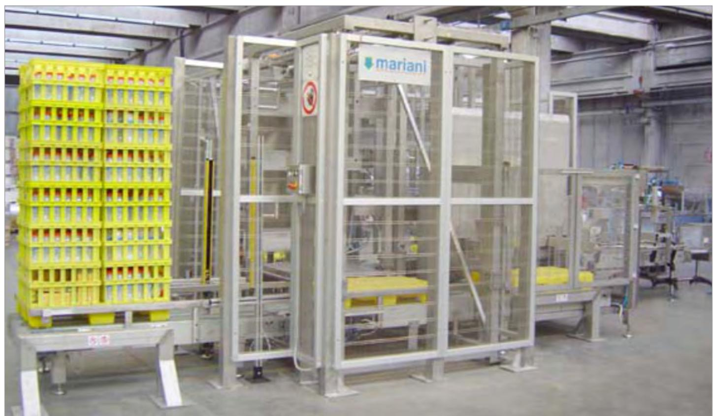
Máquina diseñada para paletizar pilas de caja de plástico o cubos de metal modelo **PMP-465**
