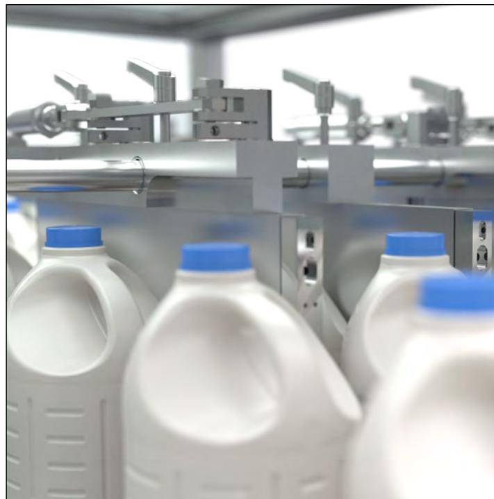
Los productos, en función de sus características y velocidad de trabajo, se clasifican y agrupan en el formato requerido para ser tomados en la cantidad deseada y sucesivamente para ser depositados en el interior de las cajas.
