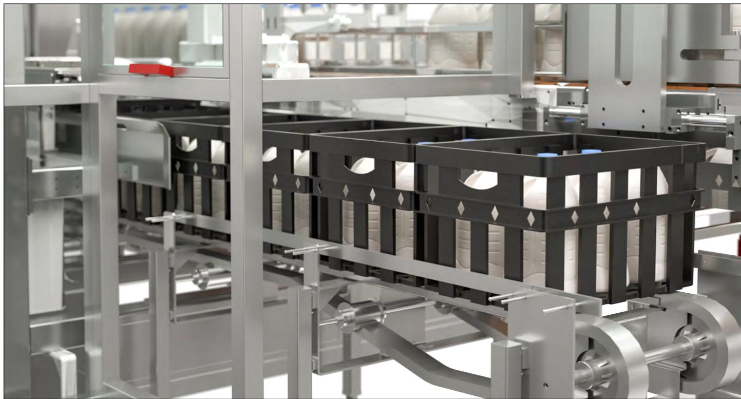
Las pinzas individuales de toma se han diseñado y construido en función del tipo de producto que hay que manipular y están constituidas por sistemas que aseguran cambios de formato rápidos, capacidades de carga elevadas y la máxima cura del producto durante las distintas fases operativas.
