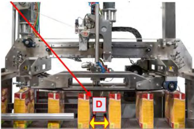
**D= 100 mm** → riduce la velocità dei pacchi in transito in macchina durante il ciclo di applicazione della maniglia.
