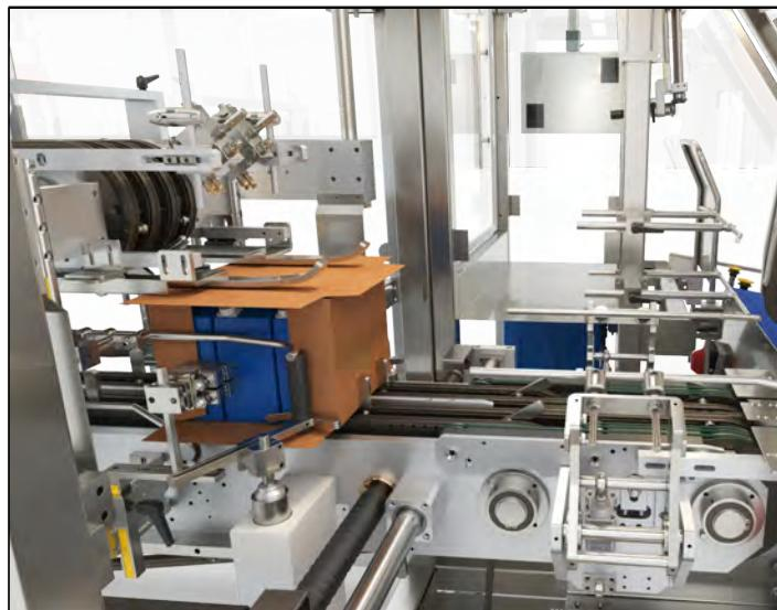
El producto, al entrar en la máquina, se separa en filas, en función del formato. Los frenos mecánicos permiten regular la entrada de producto para cada formato. En la formación, se juntan el producto con el cartón, el cual envuelve el producto. Continuando el proceso las cajas se forman completamente.
