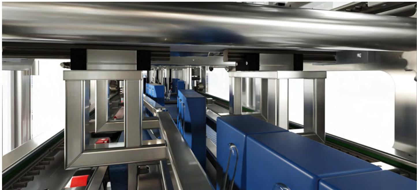
Le singole porzioni in arrivo direttamente dalla macchina riempitrice, per mezzo di un nastro trasportatore, raggiungono un dosatore che alimenta in modo regolare e continuo uno smistatore il quale devia su due o tre linee i
