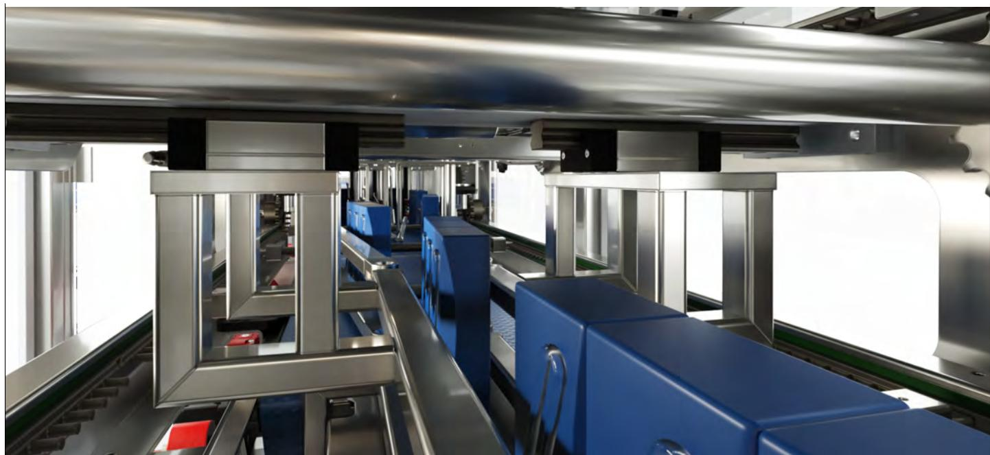
El envase primario llega por medio de una cinta transportadora al dosificador, que alimenta de forma regular y continua a un desviador que reparte el producto en dos o tres líneas, sobre las que se hace una acumulación de forma que la
