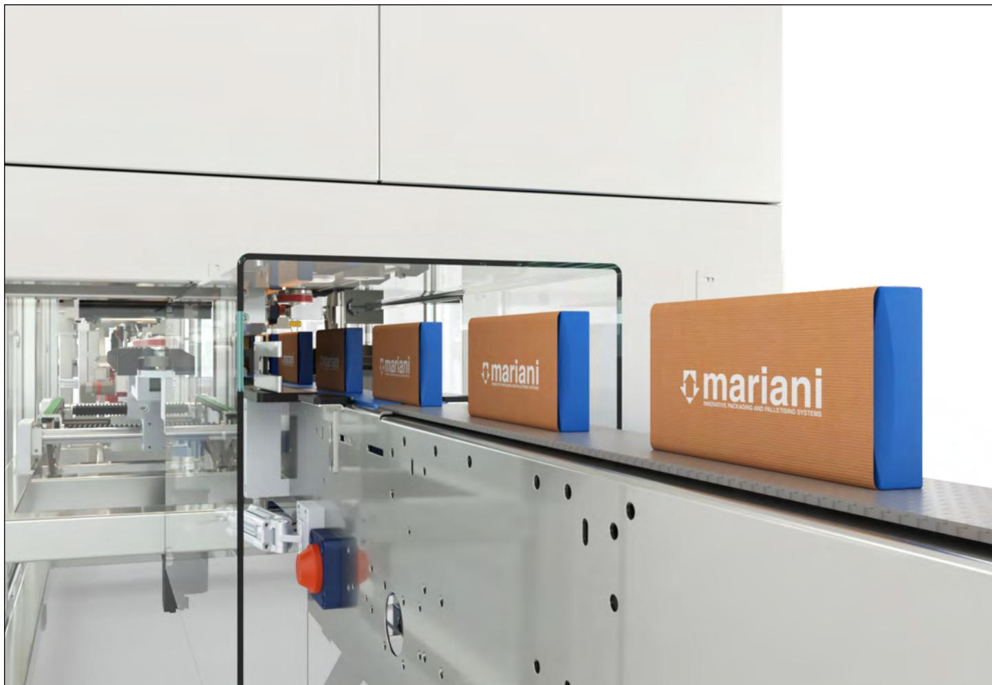
El panel operador táctil permite el control de las distintas fases operativas y la aplicación de la cola. La tecnología de servomotores, estándar para este sistema, permiten unos cambios de formato fluidos, sencillos y no requiere herramientas.
