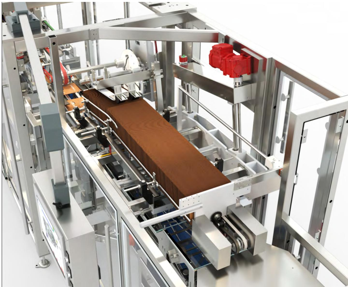
El almacén del cartón se carga lateralmente y posee un sistema de avance con presión controlada. La toma de los cartones troquelados se realiza mediante ventosas con sistema de aspiración Venturi.
